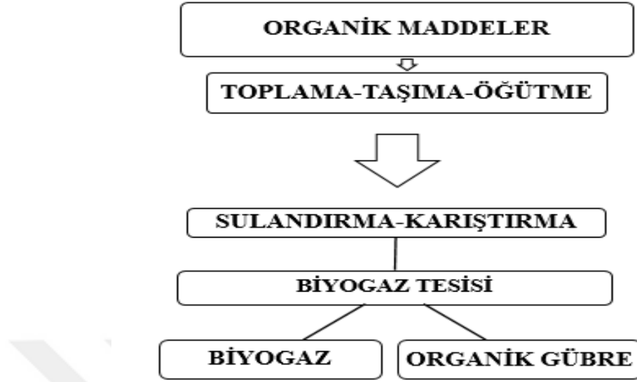
Şekil 2: Biyogaz ve Organik Gübre Üretim Akış Şeması
