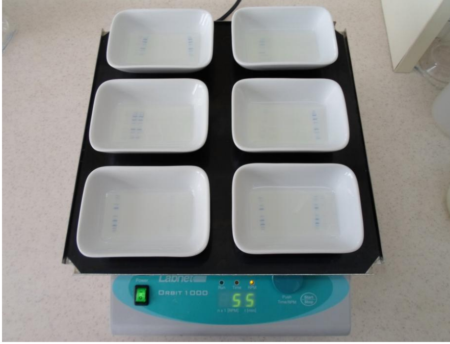
Şekil 3.13. PVDF membranların antikorlar ile çalkalayıcıda inkübasyonu
