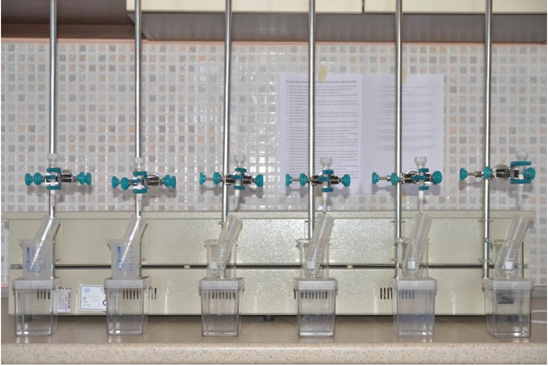
Şekil 3.3. Fosfoprotein saflaştırma kiti ile doku fosfoproteinlerinin saflaştırılması işlemi
