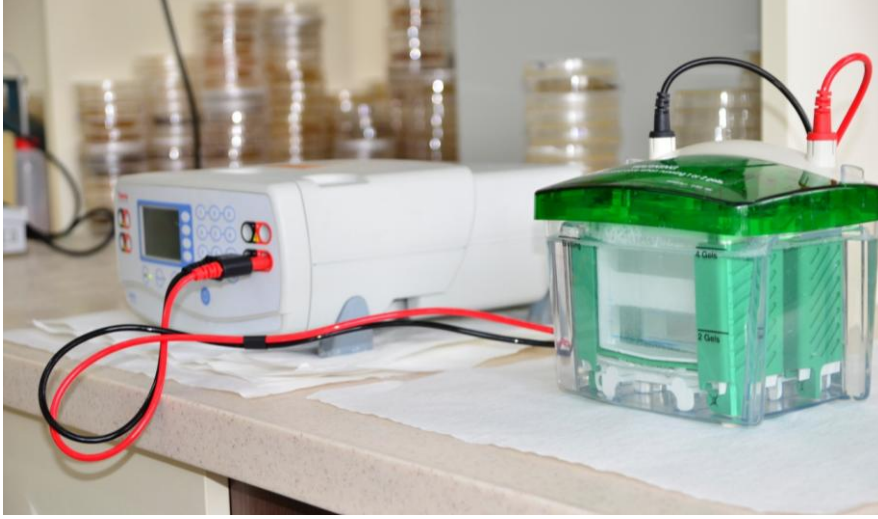
Şekil 3.7. SDS-PAGE, örneklerin yürütülmesi ve proteinlerin büyüklüklerine göre ayrıştırılması işlemi
