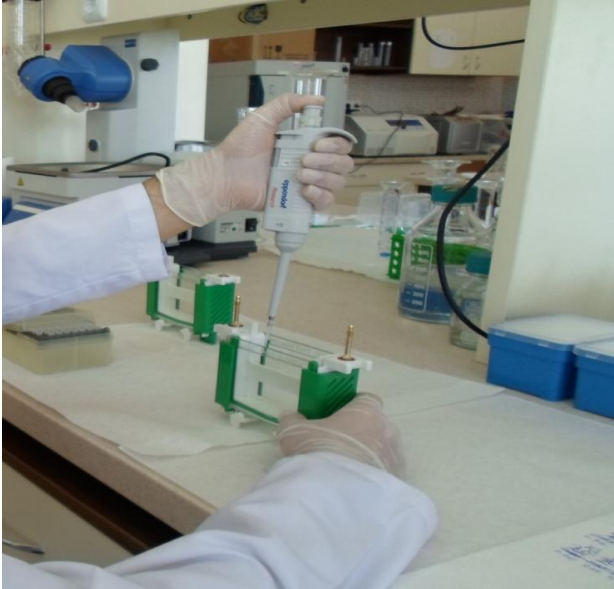
Şekil 3.6. Örneklerin jel kuyucuklarına yükleme işlemi
