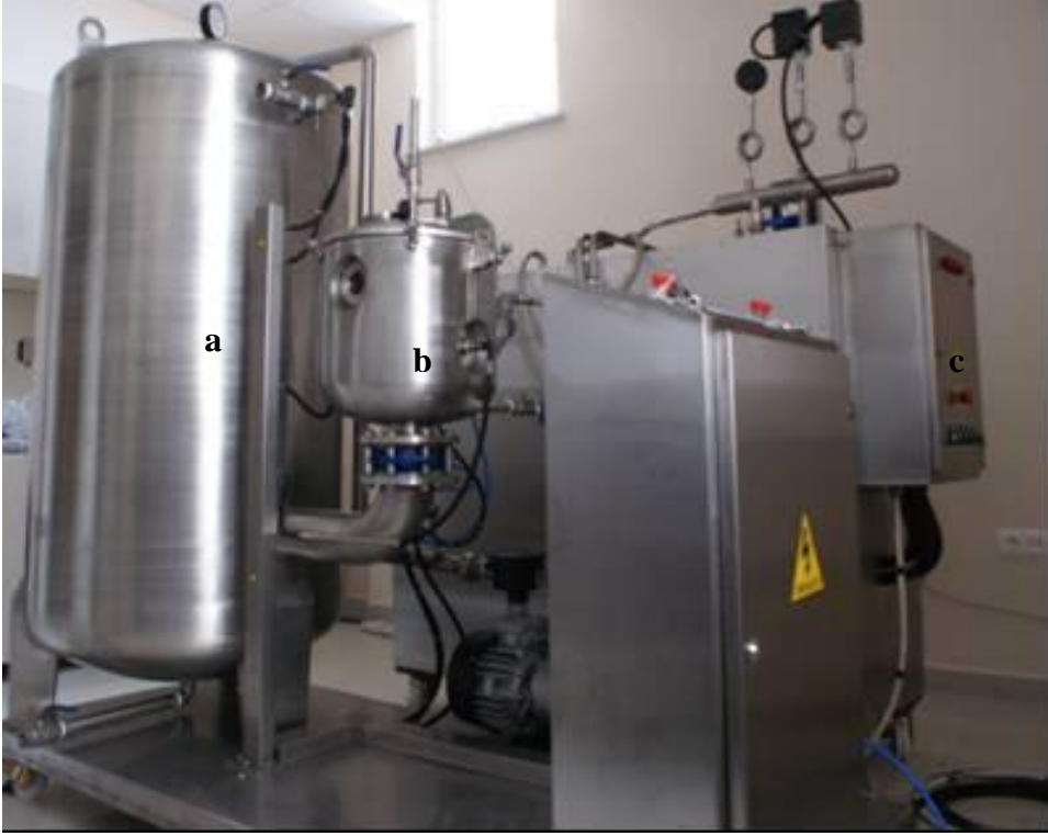
Şekil 3.1.1. KABFO cihazı a) Vakum Tankı b) Reaktör c) Buhar Jeneratörü
