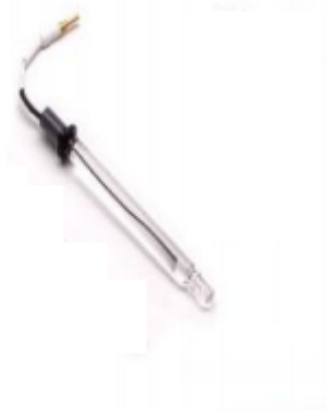
Şekil 3.2. Deneyde kullanılan BAS marka Ag/AgCl referans elektrotu
