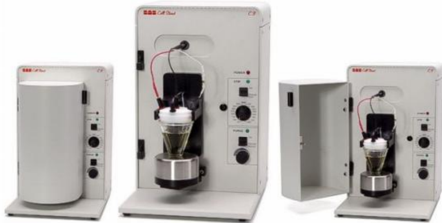
Şekil 3.1. Deneyde kullanılan elektrokimyasal sistemler ve üç elektrotlu hücre
