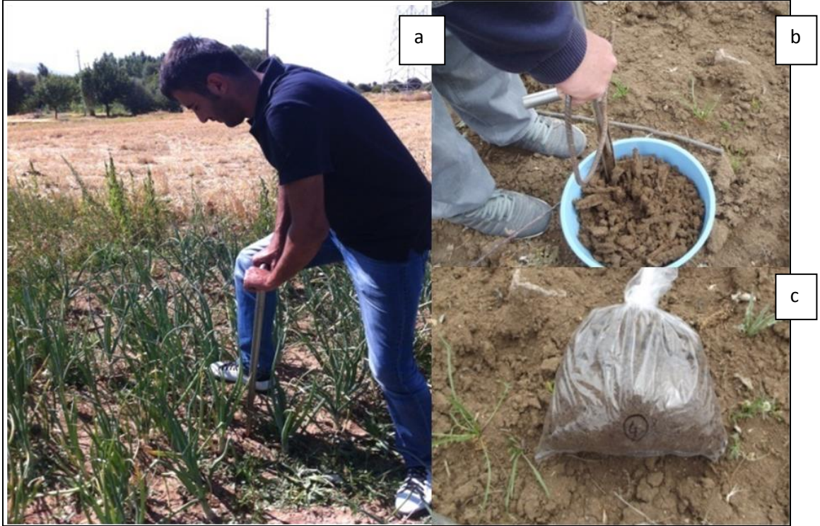
Şekil 3. 2. Toprak örneklerinin alınması aşamaları a. toprak sondası ile toprak alınması b. Alınan toprak örneğinin toprak sondasından boşaltılması, c. Plastik poşetin içine yerleştirilmiş toplam toprak örneği
