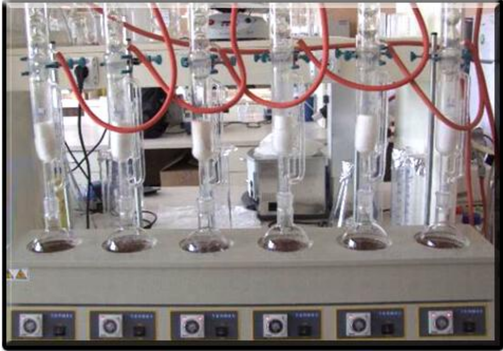
Şekil 3.2 Ekstraksiyon işleminin yapıldığı Soxhlet ekstraktörü ve kurulan düzenek
