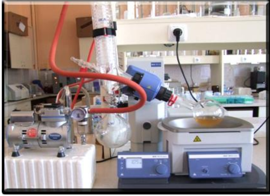
Şekil 3.3 Ekstraktların yoğunlaştırıldığı döner buharlaştırıcı
