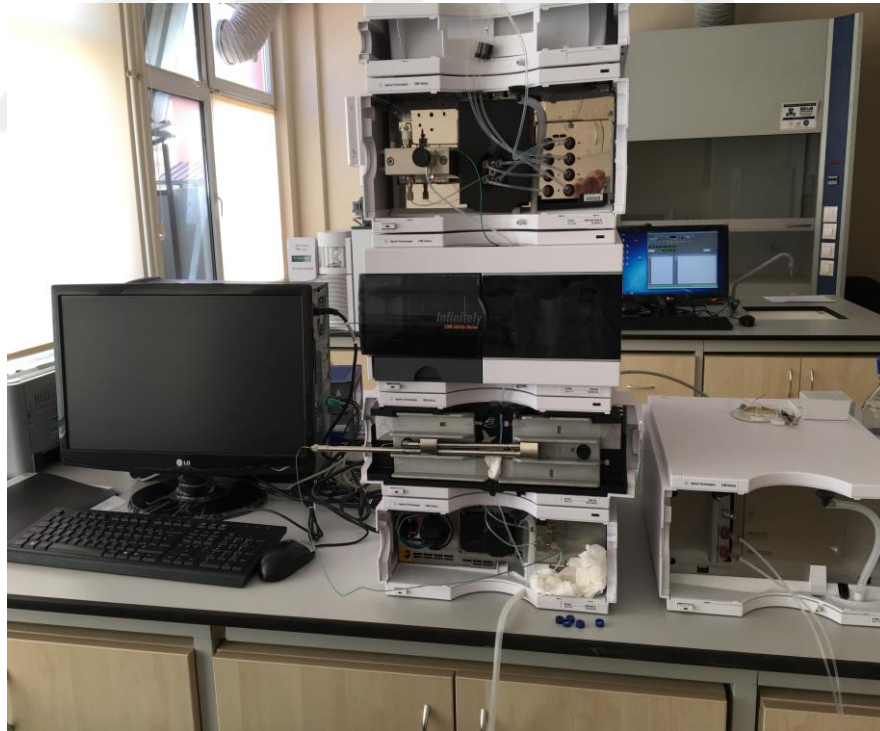
Şekil 2.6. Analizlerde kullanılan HPLC cihazı
