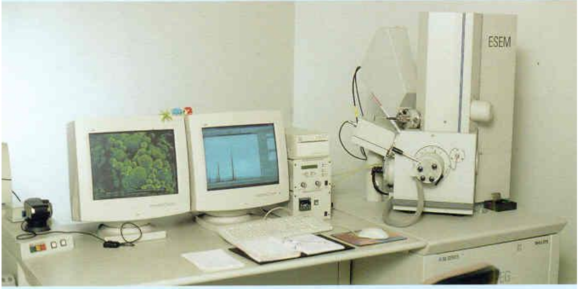
Şekil 3.2. Boğaziçi Üniversitesi AR-GE Merkez Laboratuvarları Elektron Mikroskopi ve Mikroanaliz biriminde bulunan The Philips XL30 ESEM-FEG/EDAX system Marka FEG tabanlı taramalı elektron mikroskobu
