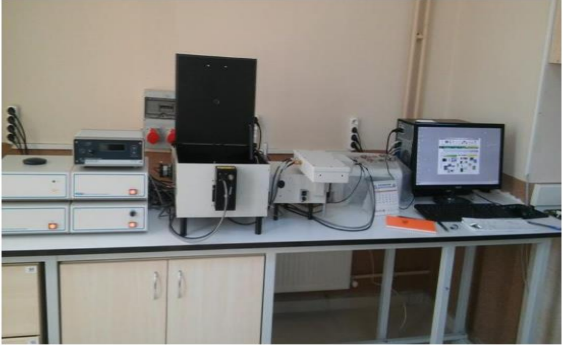
Şekil 3.1. KMÜ Mühendislik Fakültesi Metalurji ve Malzeme Mühendisliği Bölümünde bulunan PTI (Photon Technology International) Quanta Master 30 Phosphorescence/Fluorescence Spectrofluorometer marka fotoluminesans spektrofotometresi
