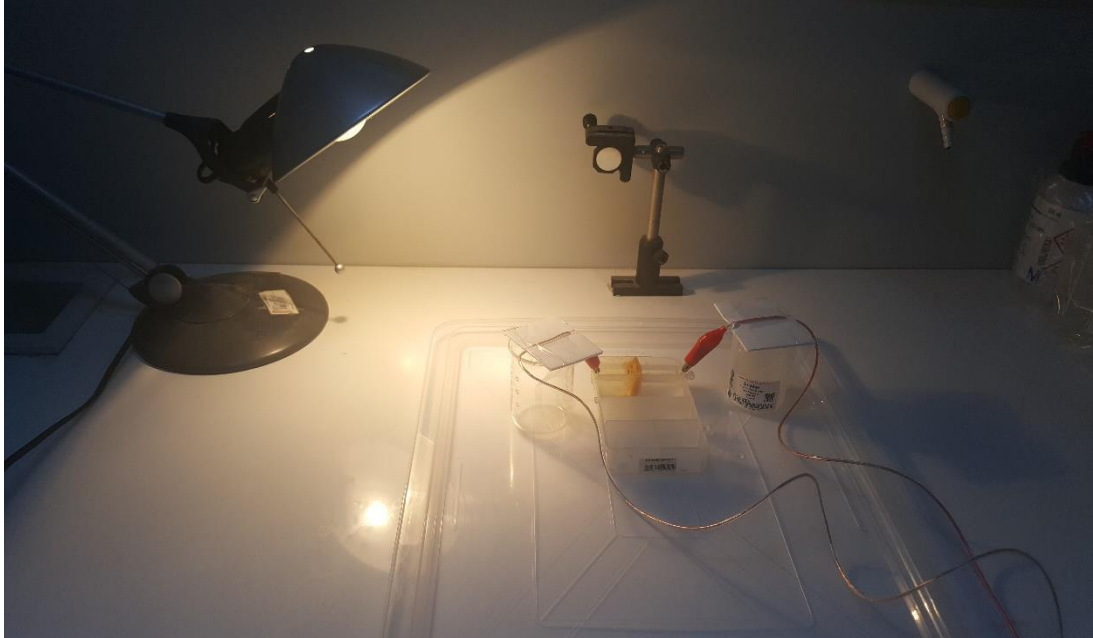
Şekil 3.6. Çift hücreli elektrokimyasal anodizasyon yönteminin deneysel düzeneği
