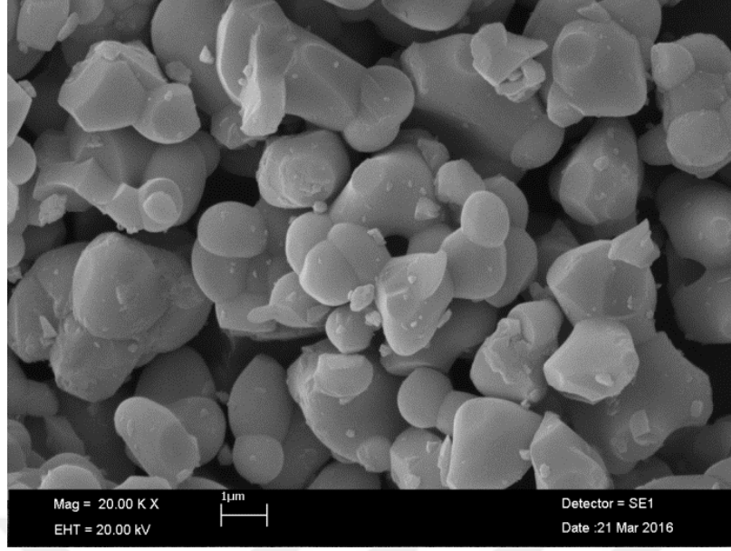
Şekil 4.45. Dy_{1.98}Yb_{0.02}Ti_2O_7 sisteminin SEM görüntüsü
