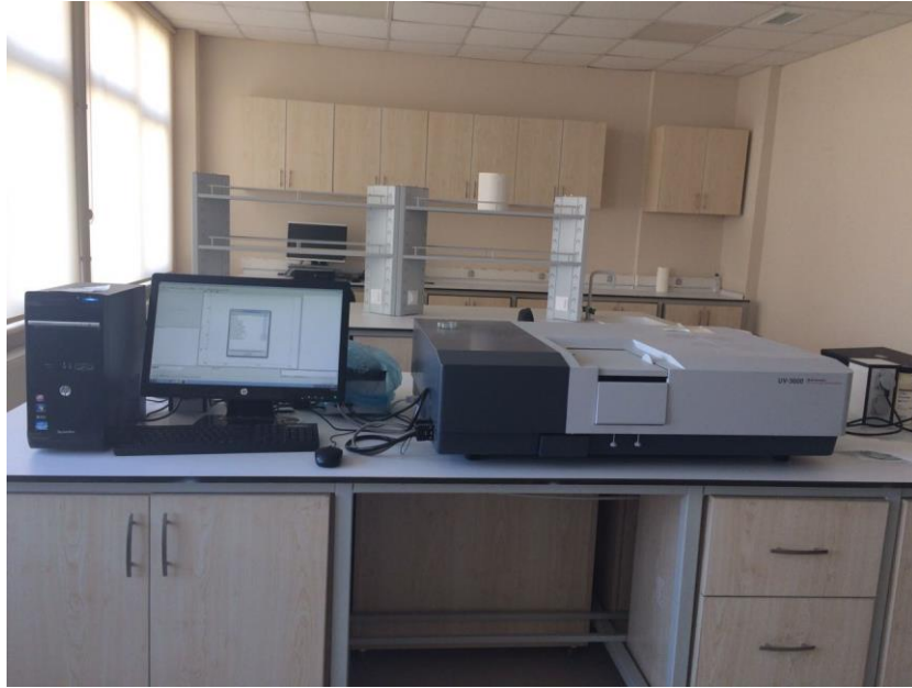
Şekil 3.2. Shimadzu UV-3600 UV-Vis-NIR Spektroskopisi
