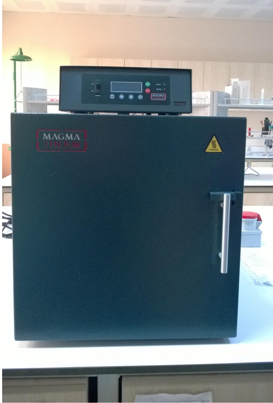
Şekil 3.10. Magmatherm marka MT1105-S-E4 model kül fırını
