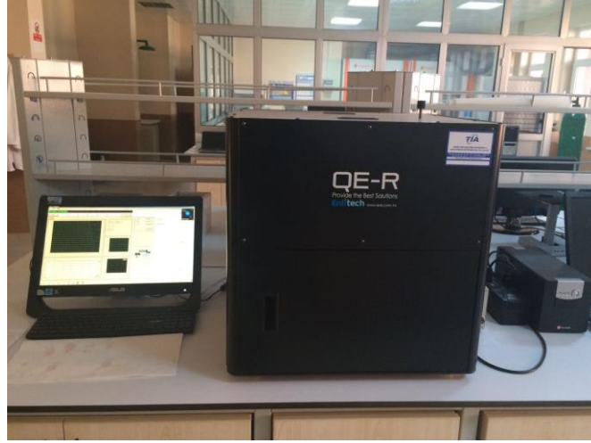
Şekil 3.3. 75 W Xenon ark lamba kaynağı olan Enlitech QE-R marka IPCE cihazı
