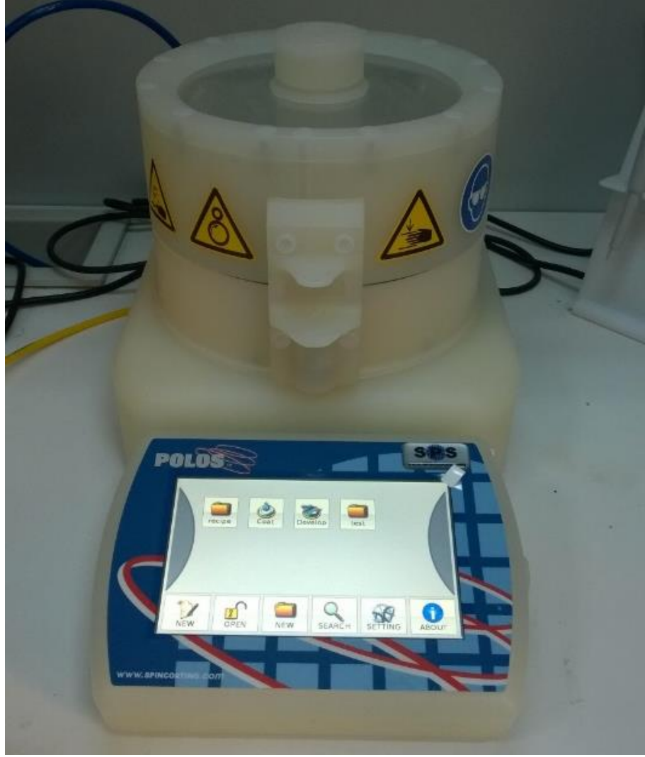
Şekil 3.14. Polos marka SPIN150i model döndürme kaplama cihazı
