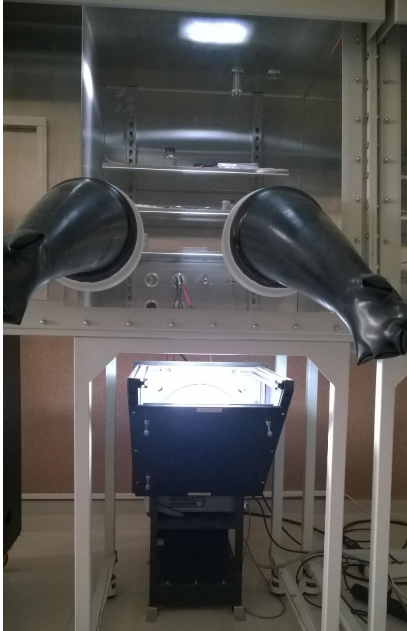
Şekil 3.9. 1000 W lık OAI Marka Trisol Sınıf AAA güneş simülatörü
