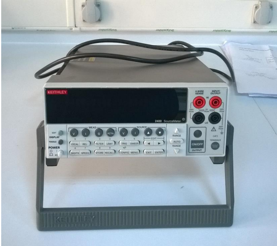
Şekil 3.8. Keithley 2400 Akım-Gerilim Ölçer
