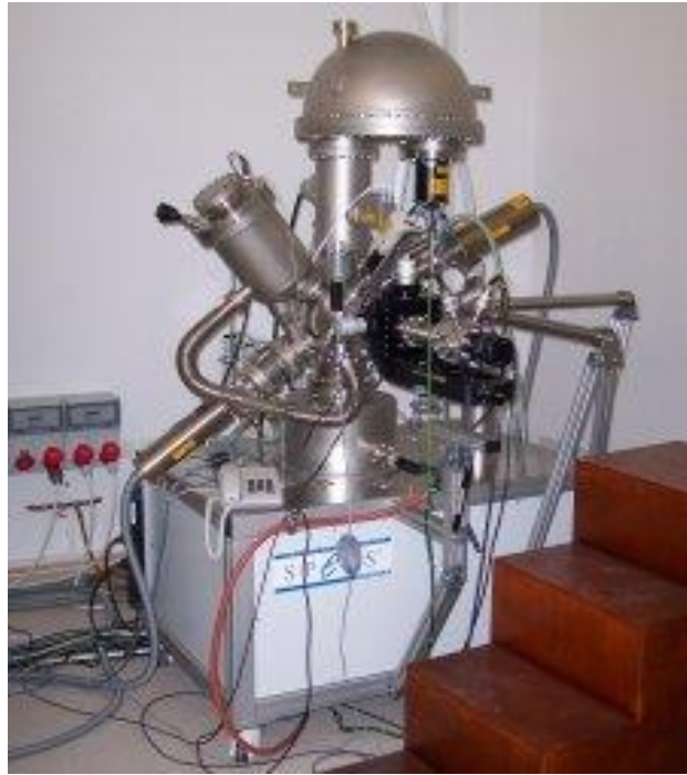
Şekil 3.5. SPECS EA 300 marka XPS cihazı
