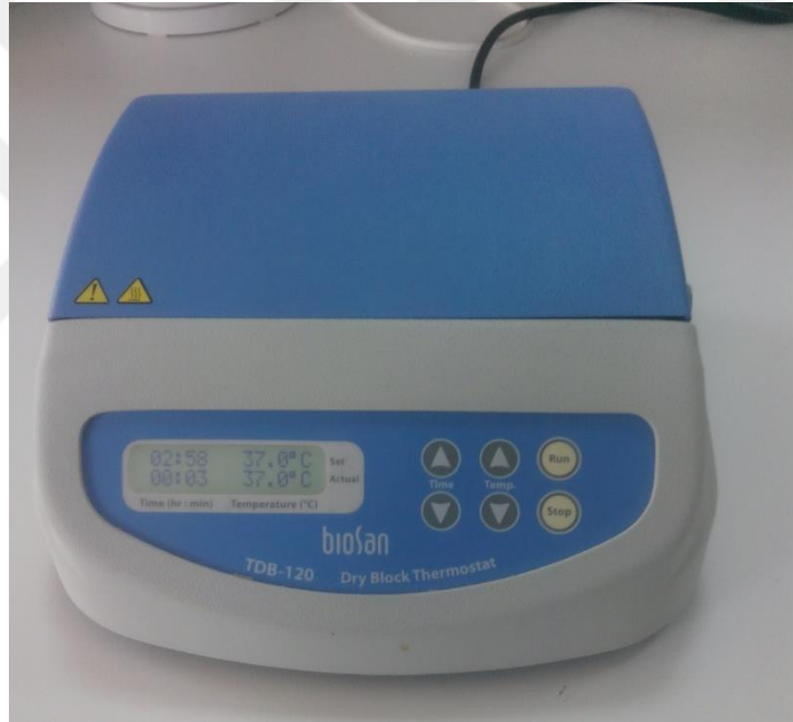
řekil 3.8. Restriksiyon enzimi alıřmalarında kullanılan ısıtıcı blok
