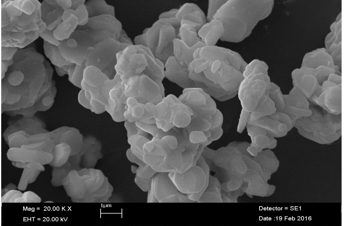
Şekil 4.9. Ba 0.5 Ca 0.5 Gd 2 (MoO 4 ) 4 :0.05 mol Eu 3+ , 0.01 mol Dy 3+ ışıldar sisteminin 20.000 kat büyütülmüş SEM görüntüsü
