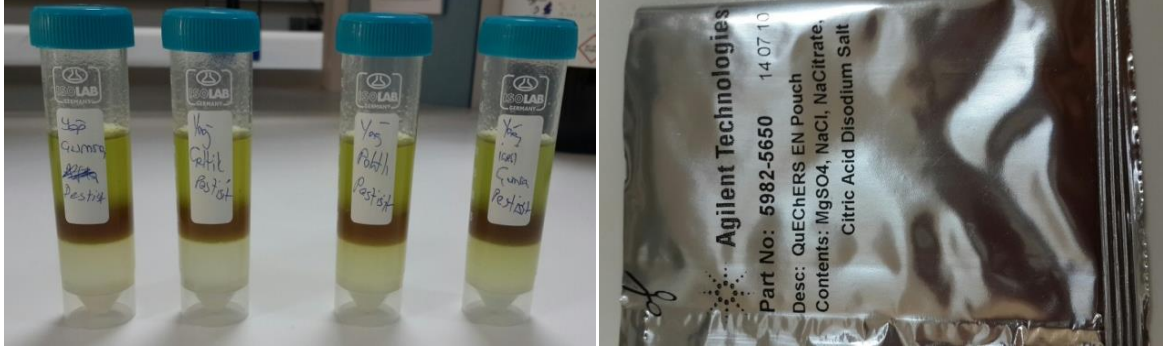
Şekil 3. 3 Pestisit tayini için uygulanan AOAC 2007.01-QuEChERS metodu numune hazırlama prosedürü
