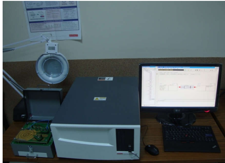
Şekil 3.2.6. Keithley 4200-SCS yarıiletken karakterizasyonu sistemi.
