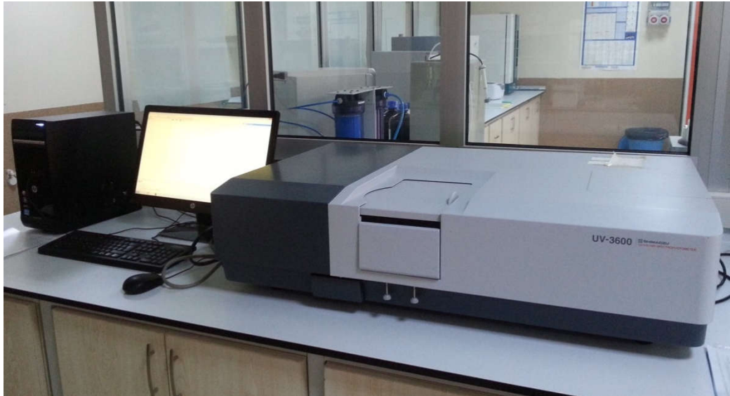
Şekil 3.2.4. Optiksel özelliklerin belirlendiği UV-Vis-NIR spektrofotometresi.
