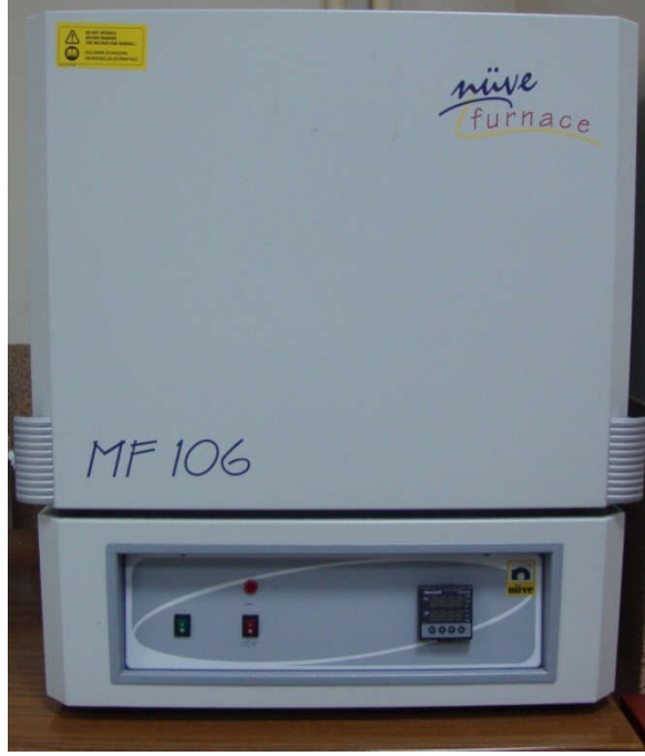
Şekil 3.2.3. 0-1100 °C aralığında çalışabilen Nüve MF106 kül fırını.
