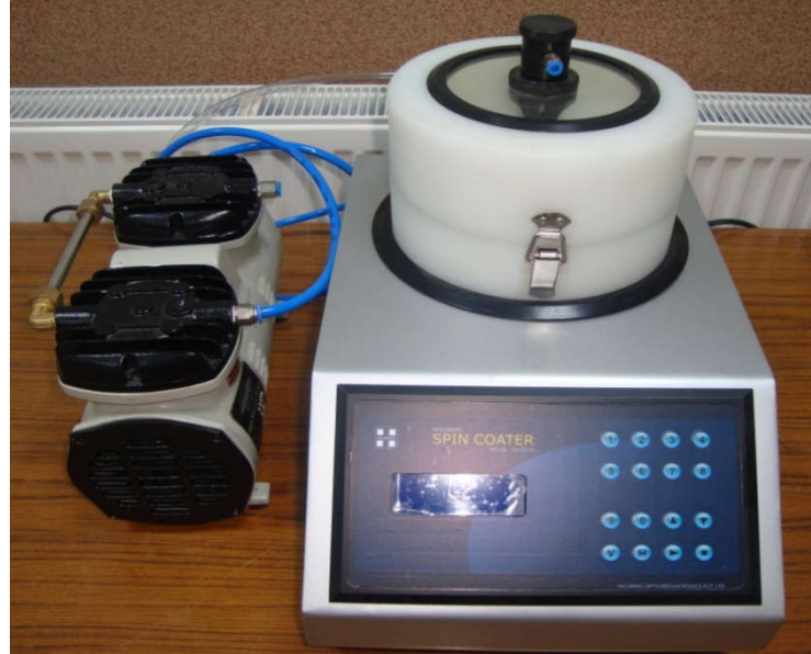
Şekil 3.2.2. Bilgisayar kontrollü Holmarc spin coating H0-TH-05 sistemi.
