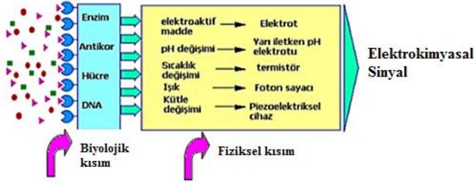
Şekil 2.5. Biyolojik sensörün şematik gösterimi (Kılıç, 2011)
