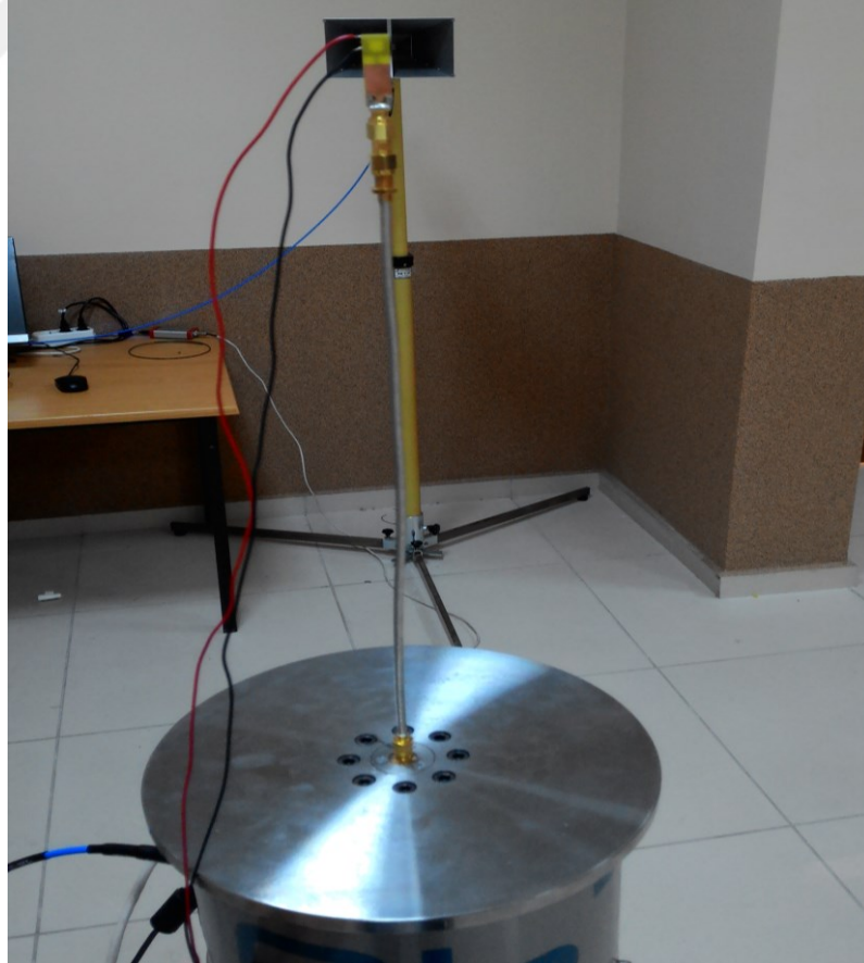
Şekil 4.27. G şekilli bant çentik anahtarlamalı UGB antenin ışınma örüntüsü ölçümleri
