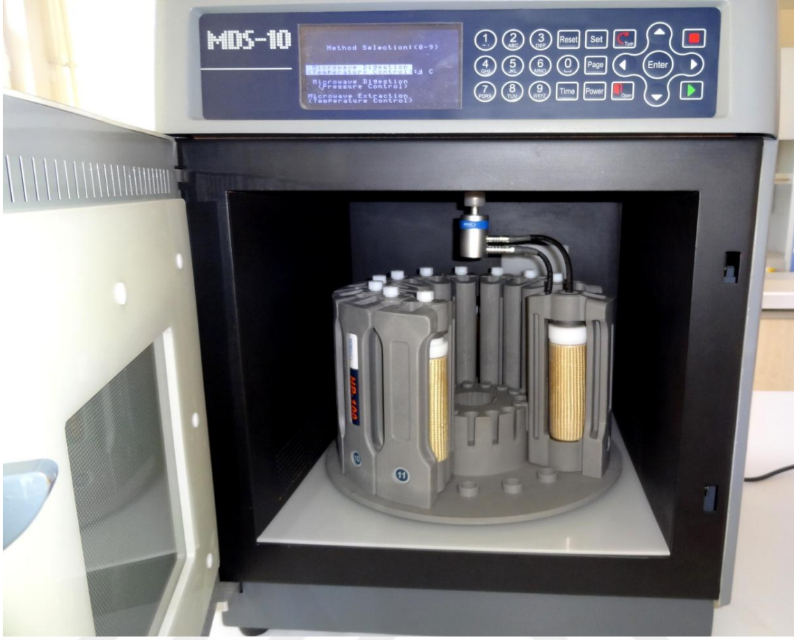
Şekil 3.1. SINEO MDS-10 mikrodalga fırınına yerleştirilen örnekler
