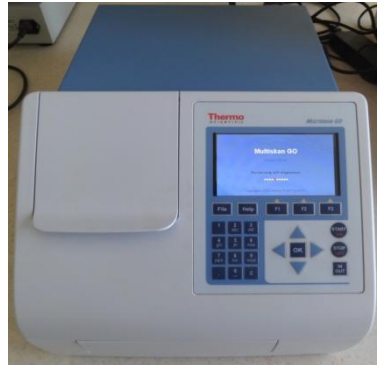
Şekil 3.4. Spektrofotometrik ölçümlerin yapıldığı cihaz (Thermo Fisher Scientific, Multiskan Go)
