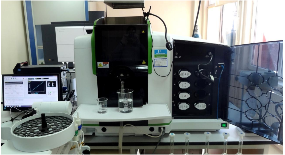
Şekil 3.2. Ağır metal analizinde kullanılan Perkin Elmer PinAAcle 900T AAS cihazı
