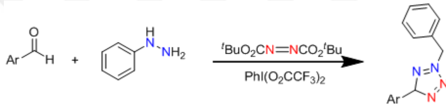
Şekil 1.5.7. Fenilhidrazinin ile tetrazol sentezi
