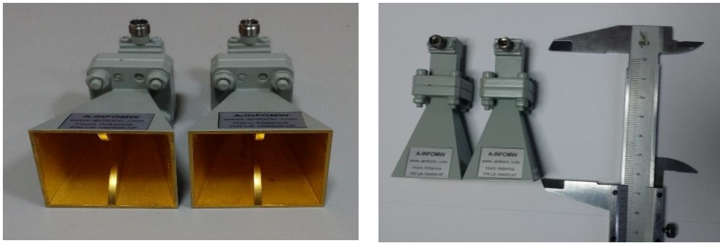
Şekil 3.11 A-INFO INC LB- 180400 Huni(Horn) antenler
