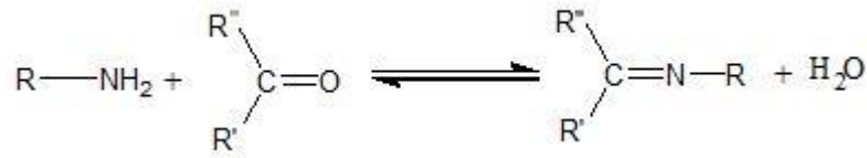
Şekil 2.3. N-aril veya N-alkil sübstitüe imin yapısında bulunan Schiff bazları.
