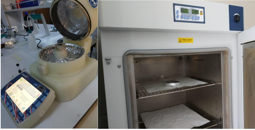
Şekil3.2. SPS Polos SPIN150i/200i model döndürme kaplama ve ısıl işlem sistemi
