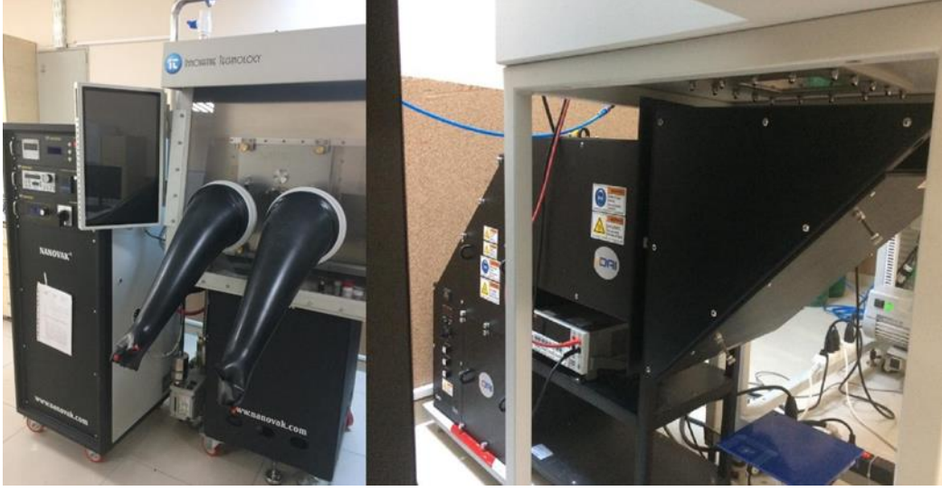
Şekil 3.3. Havasız ortam kabinine (Glove Box) yerleştirilmiş PVD cihazı ve OIA Güneş simülatörü
