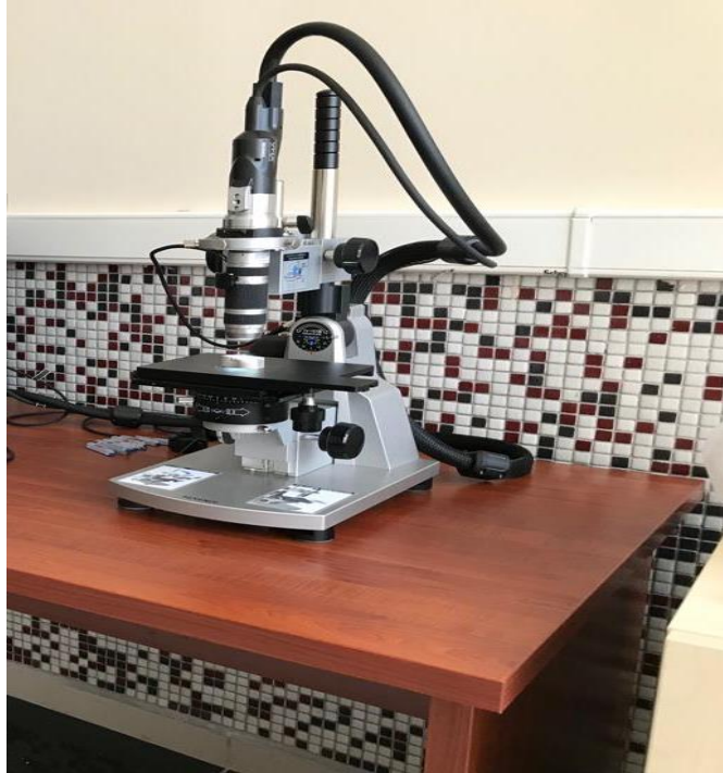
Şekil 3.6. Aşınma ve talaş ölçümünde kullanılan dijital mikroskop
