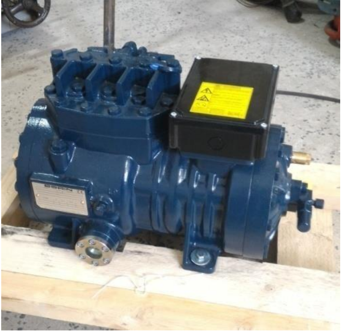
Şekil 5.4. CO 2 'li sistemde kullanılan kompresör.
