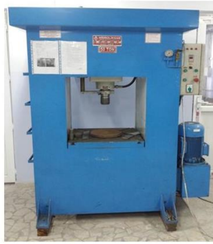
Şekil 5.4. Soğuk pres işleminin yapıldığı hidrolik presin görüntüsü.
