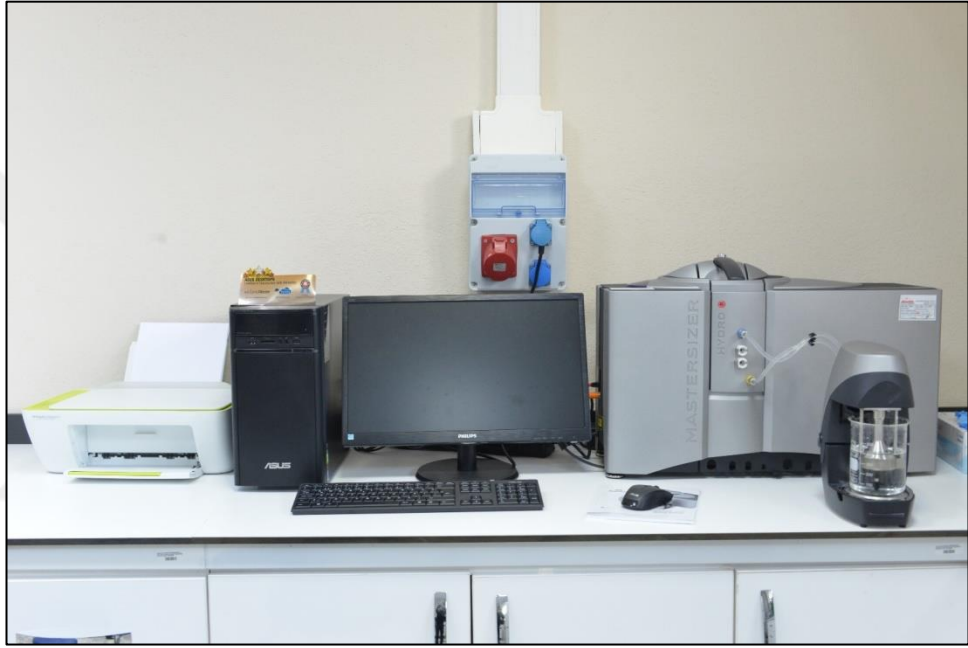
Şekil 5 2. Toz boyutu ölçümlerinin yapıldığı cihazın görüntüsü.
