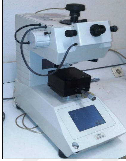
Şekil 5.8. Sertlik ölçümlerinin yapıldığı mikro sertlik ölçüm cihazı.
