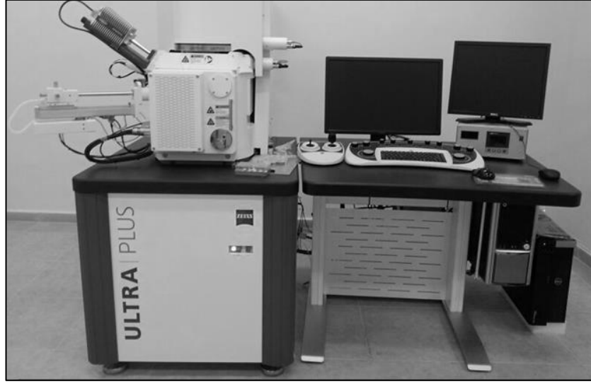
Şekil 5.10. SEM ve EDS deneylerinin yapıldığı taramalı elektron mikroskobunun görüntüsü.
