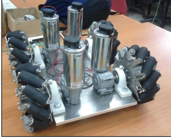
Şekil 5.6. Mekaniksel montajı tamamlanmış mobil robotun görünümü.
