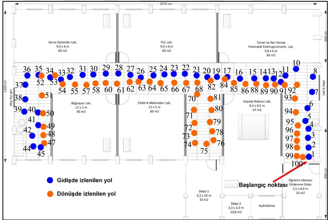
Şekil 7.4. Alan tarama deneyinin birinci tekrarında robotun çalışma ortamı planı üzerindeki yaklaşık gösterimi.
