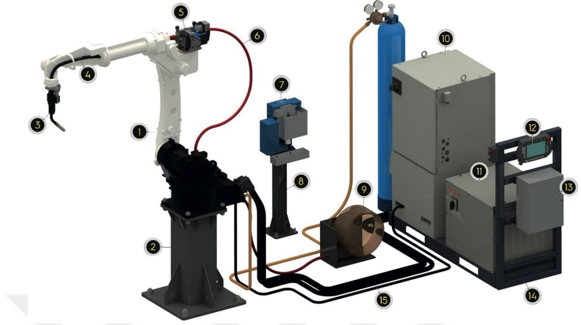
Şekil 5.2. Kaynak robotunun ekipmanlarının gösterimi [23].
