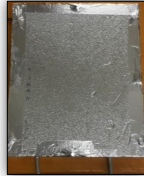
Şekil 3.4. Geliştirilen serpantinli su soğutmalı panelin (SRP) imalatı ve montajı.
