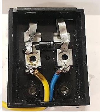
Şekil 3.6. Panelin elektrik çıkış bağlantısının yapılması.
