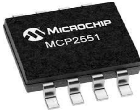
Şekil 4.28. MCP2551 Entegrenin resmi.
