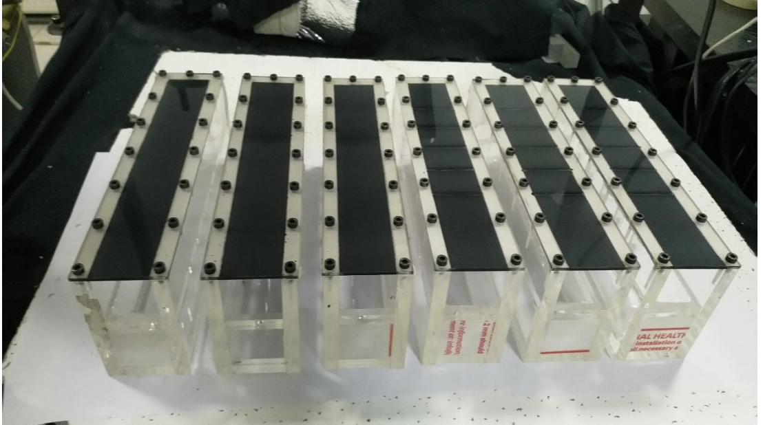
Şekil 3.12. Hedef yüzeylerin test modellerine montajı.
