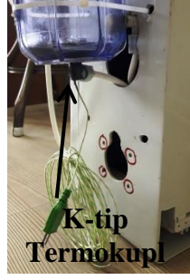
Şekil 5.10. Geri dönüşüm hattına yerleştirilen K-tip termokupl.
