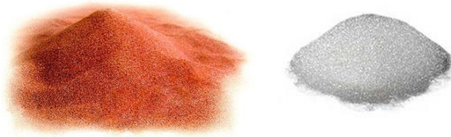
Şekil 2.27. Mikro kumlama yönteminde granül malzeme olarak kullanılan garnet ve cam küre kumu (İnternet, 7).
