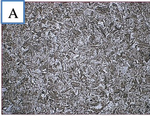
Şekil 6.12. 860°C için 1000x büyütme A:1. grup, B:2. grup.
