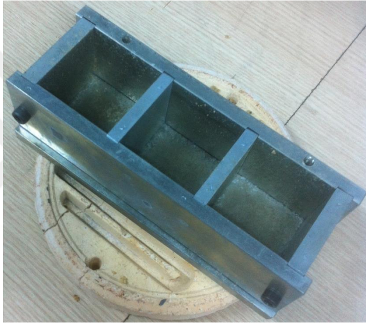
Şekil 4.1. Numune şekillendirmede kullanılan çelik kalıp.
