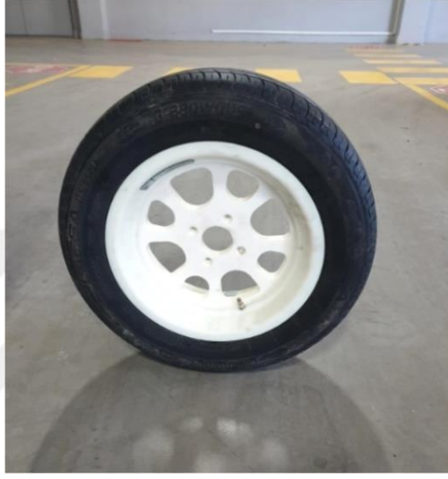
Şekil 7.3. Güçlendirilmiş döküm poliamid ile üretilmiş otomobil jantı.
