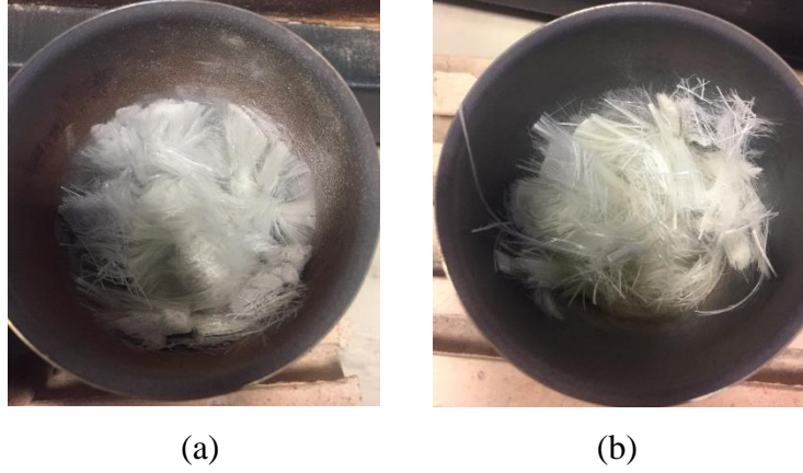
Şekil 7.1. (a) Kalın kesitli CTP kompozitlerden çıkarılan ve (b) ince kesitli CTP kompozitlerden çıkarılan cam elyafların görünüşleri.
