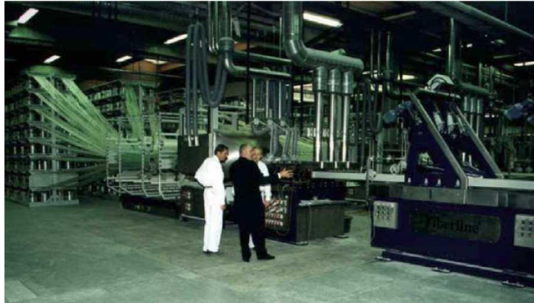
Şekil 5.4. Fiberimsi pultruzyon (toz alma) ekipmanları [14].
