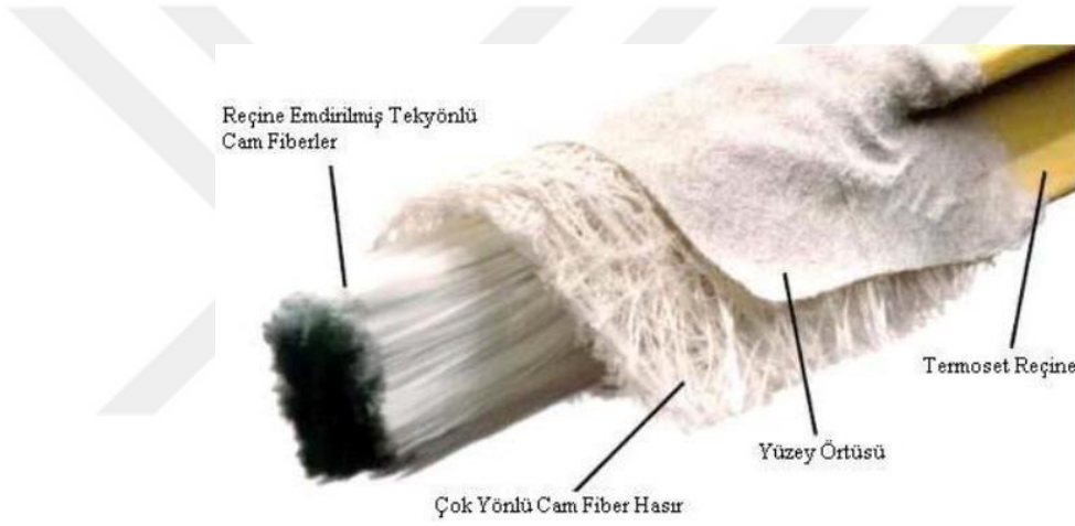
Şekil 5.5. Pultrüzyon metodu ile üretilmiş profil detayı [34].
