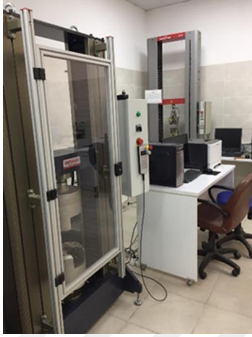
Şekil 7.3. Mekanik özelliklerin belirlenmesinde kullanılan Besmark model çekme cihazı.
