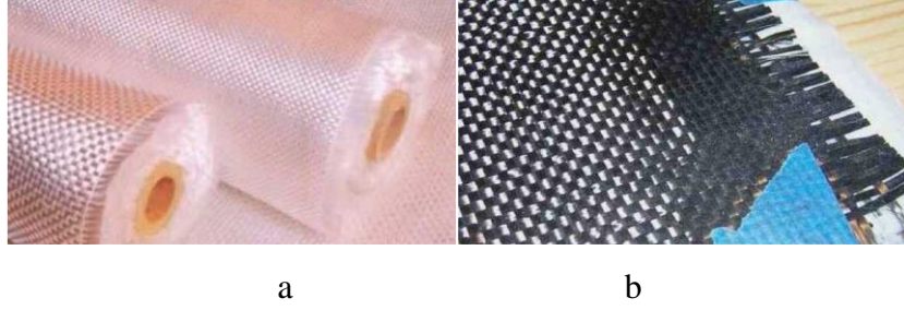
Şekil 2.3. (a) Cam fiber kumaş [15] (b) Karbon fiber kumaş [16].
