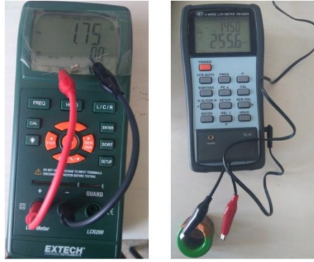
Şekil 5.16. Direnç ve bobin elemanların ölçülmesi.
