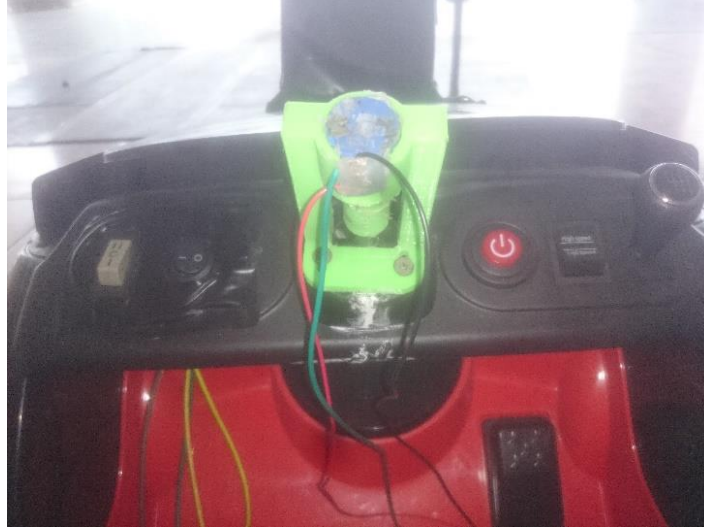
Şekil 4. 14. Direksiyon miline montaj edilen potansiyometrenin görünümü.
