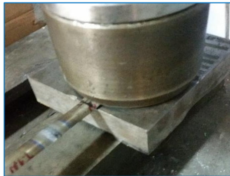
Şekil 5.7. Çekme numunelerinin çekme çenesi tutma yerlerinin preste düzeltilmesi.
