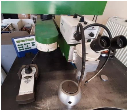
Şekil 5.4. Lazer kaynak makinası ve kaynağın yapılışı.
