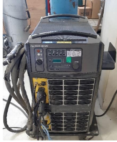
Şekil 5.2. TIG kaynak makinası.
