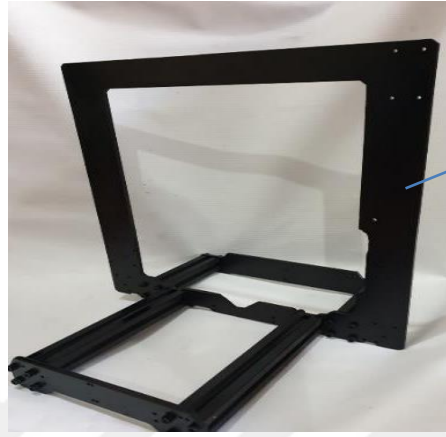
Şekil 4.3. 5 eksen 3B yazıcı çelik sactan imal edilen gövde.
