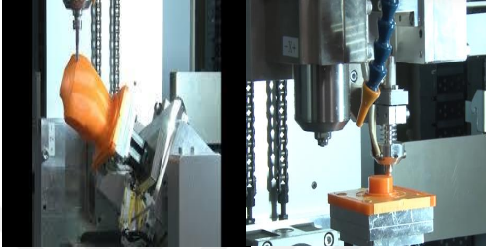
Şekil 2.14. 5 eksen hibrit 3B yazdırma [27].
