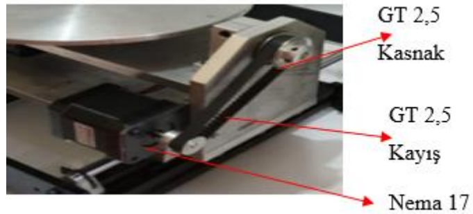
Şekil 4.7. Motor hareket aktarımı.
