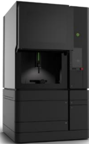
Şekil 2.15. Vshaper hibrit 5 eksen yazdırma [28].
