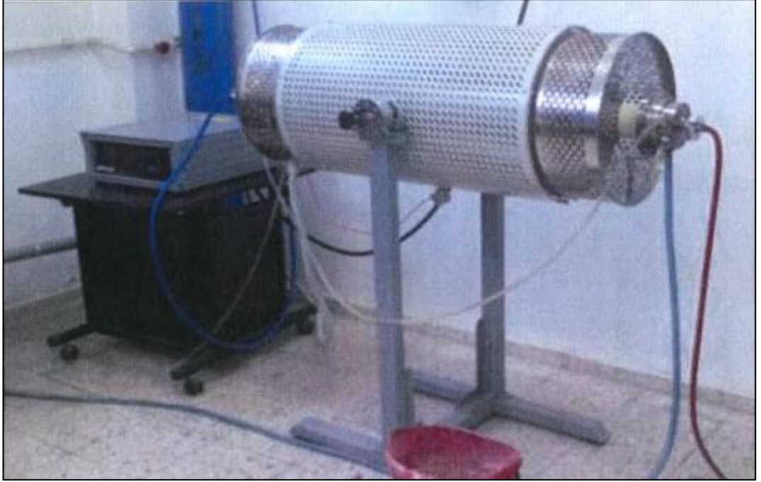
Şekil 0.2. Deneysel çalışmalarda kullanılan atmosfer kontrollü fırın.
