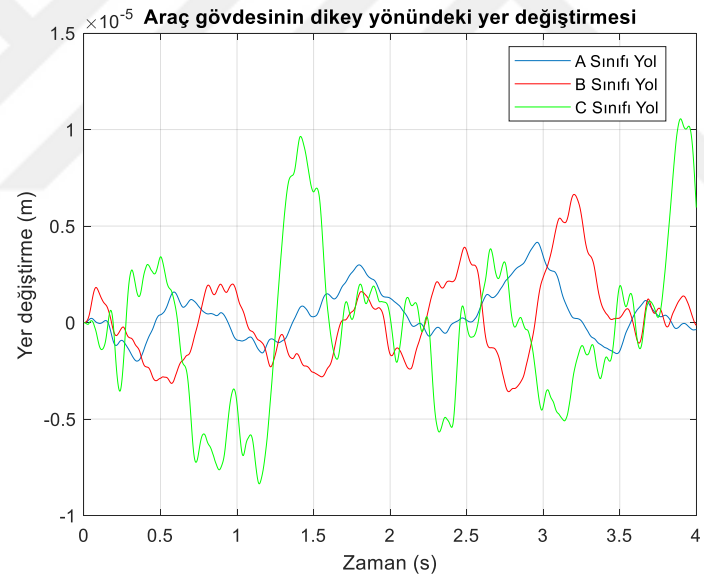
Şekil 6.9. A, B, C sınıfı yol pürüzlülüğünde araç gövdesi dikey yönündeki yer değişimi grafikleri.
