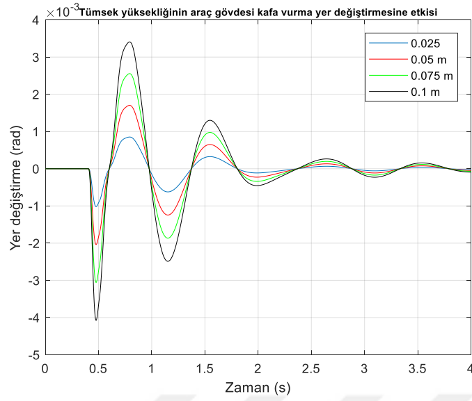
Şekil 6.26. Tek tümsek yol profilinde araç gövdesinin kafa vurma yönündeki yer değiştirmeleri.
