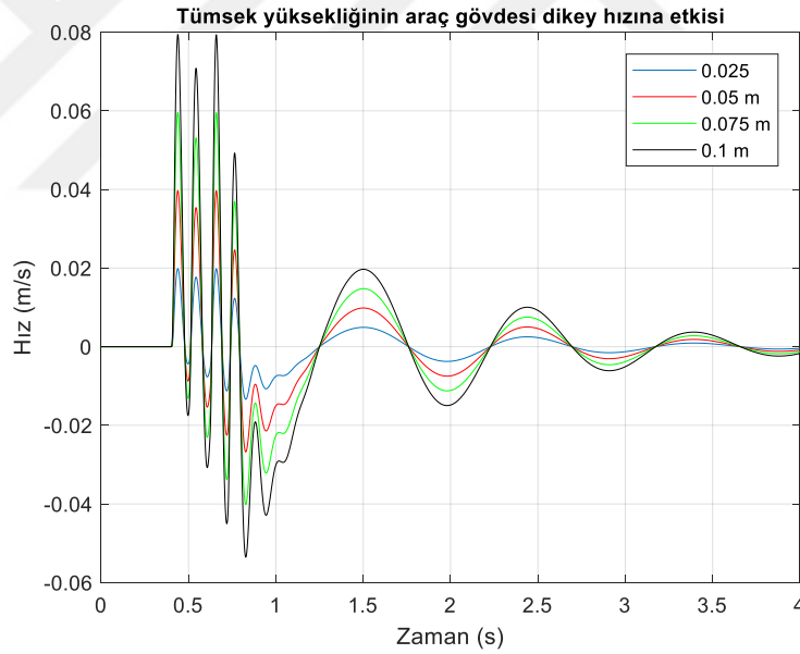
Şekil 6.45. Aynı yükseklikte iki tümseğe sahip yol profilinde araç gövdesinin dikey yönündeki hızları.
