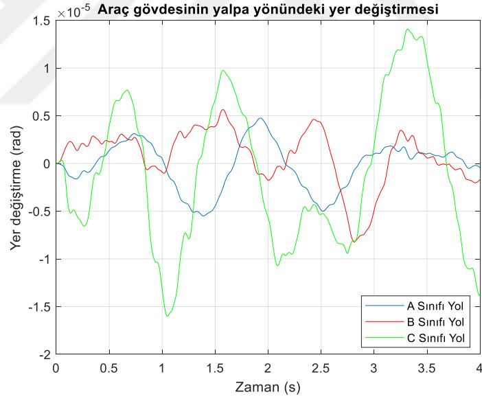
Şekil 6. 11. A, B, C sınıfı yol pürüzlülüğünde araç gövdesi yalpa yönündeki yer değişimi grafikleri
