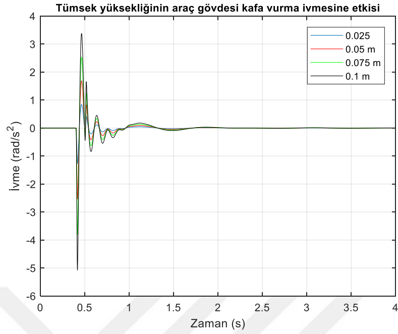
Şekil 6.34. Tek tümsek yol profilinde araç gövdesinin kafa vurma yönündeki ivmeleri.
