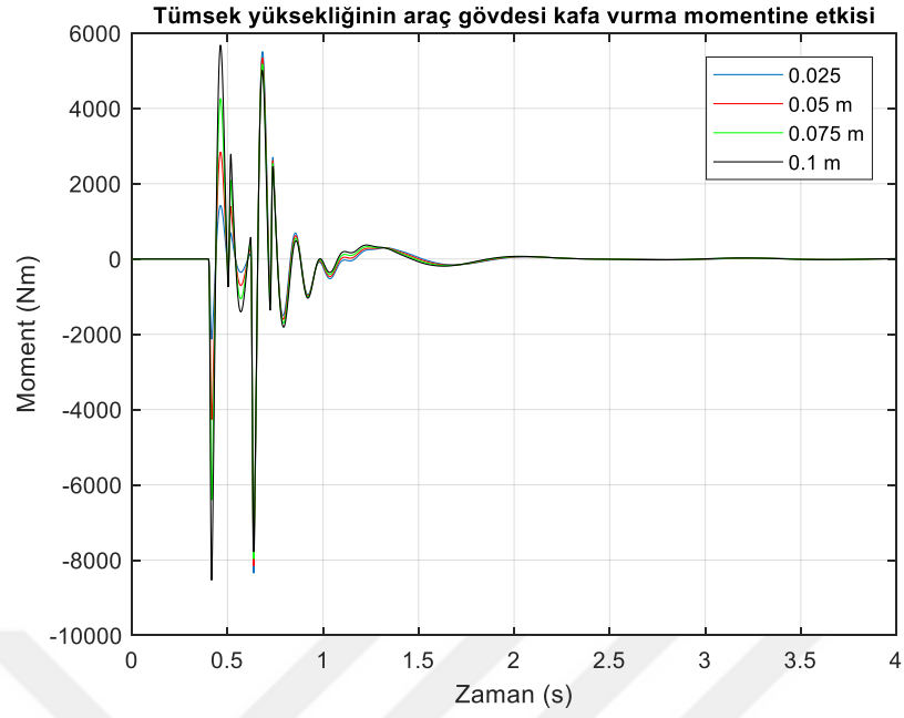
Şekil 6.86. İkinci tümsek yüksekliği 0,1 m, birinci tümsek yüksekliğinin değişmesinin araç gövdesine etki eden kafa vurma yönündeki momente olan etkisi.
