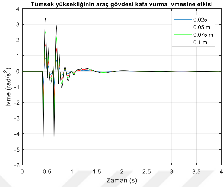
Şekil 6.50. Aynı yükseklikte iki tümseğe sahip yol profilinde araç gövdesinin kafa vurma yönündeki ivmeleri.
