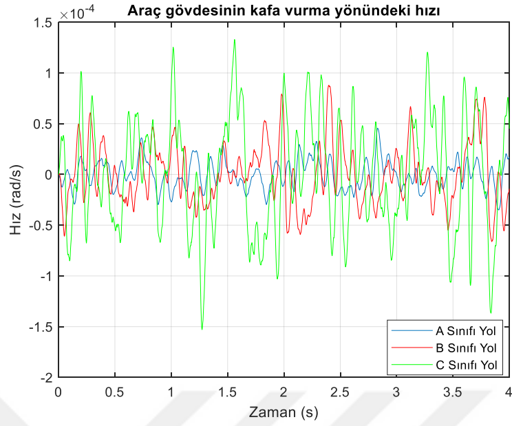
Şekil 6.14. A, B, C sınıfı yol pürüzlülüğünde araç gövdesinin kafa vurma yönündeki hız grafikleri.
