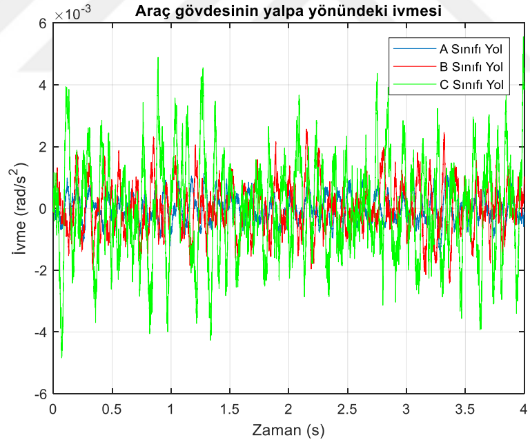
Şekil 6.19. A, B, C sınıfı yol pürüzlülüğünde araç gövdesinin yalpa yönündeki ivme grafikleri.
