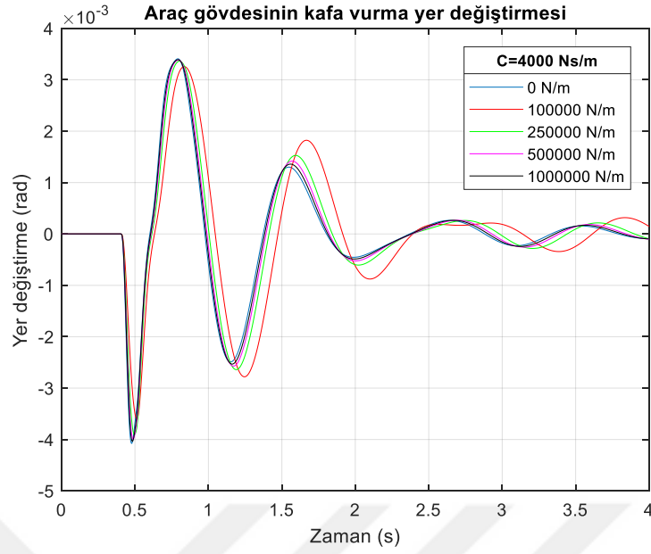
Şekil 6.122. C=4000 , yol yaylanmasının araç gövdesinin kafa vurma yönündeki yer deęiştirmesine olan etkisi.
