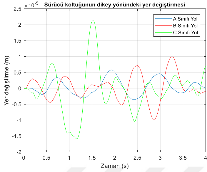
Şekil 6.8. A, B, C sınıfı yol pürüzlülüğünde sürücü koltuğu dikey yönündeki yer değişimi grafikleri.
