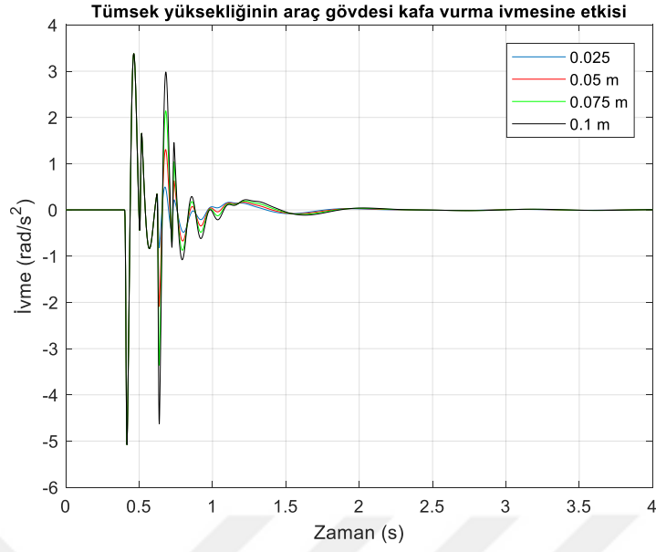
Şekil 6.66. Birinci tümsek yüksekliği 0,1 m, ikinci tümsek yüksekliğinin değişmesinin araç gövdesinin kafa vurma yönündeki ivmesine olan etkisi.
