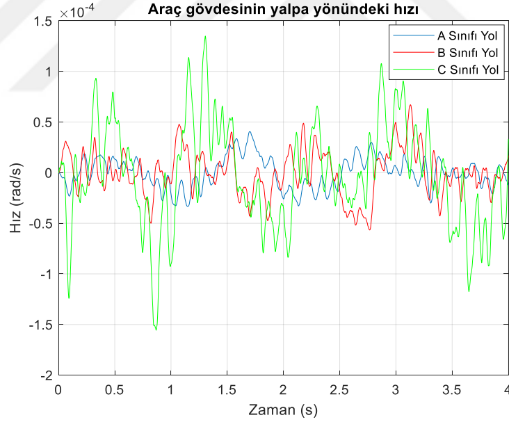
Şekil 6.15. A, B, C sınıfı yol pürüzlülüğünde araç gövdesinin yalpa yönündeki hız grafikleri.
