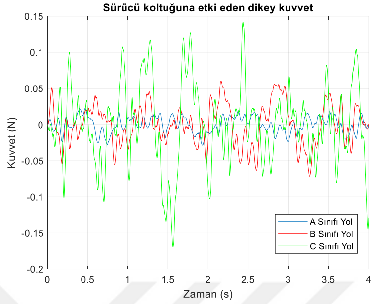
Şekil 6.20. A, B, C sınıfı yol pürüzlülüğünde sürücü koltuğunun dikey yönündeki kuvvet grafikleri.
