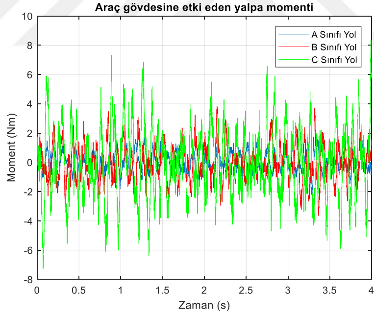
Şekil 6.23. A, B, C sınıfı yol pürüzlülüğünde araç gövdesinin yalpa yönündeki moment grafikleri.
