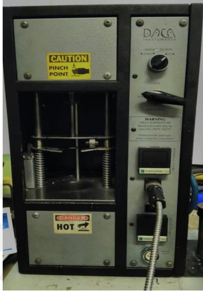
Şekil 5.3. Dacca marka enjeksiyonlu kalıplama cihazı.
