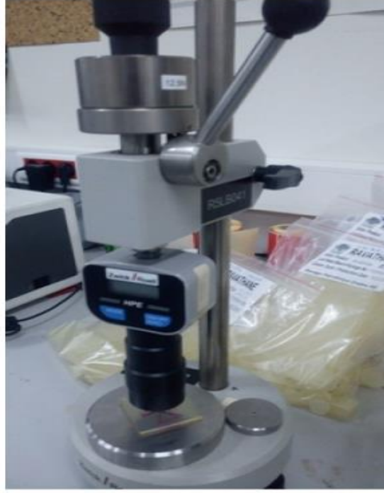
Şekil 5.9. Zwick R5LB041 marka sertlik ölçme cihazı.
