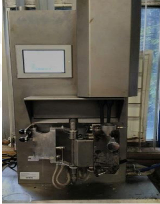
Şekil 5.2. DSM Xplore marka 15 cc çift vidalı extruder cihazı.
