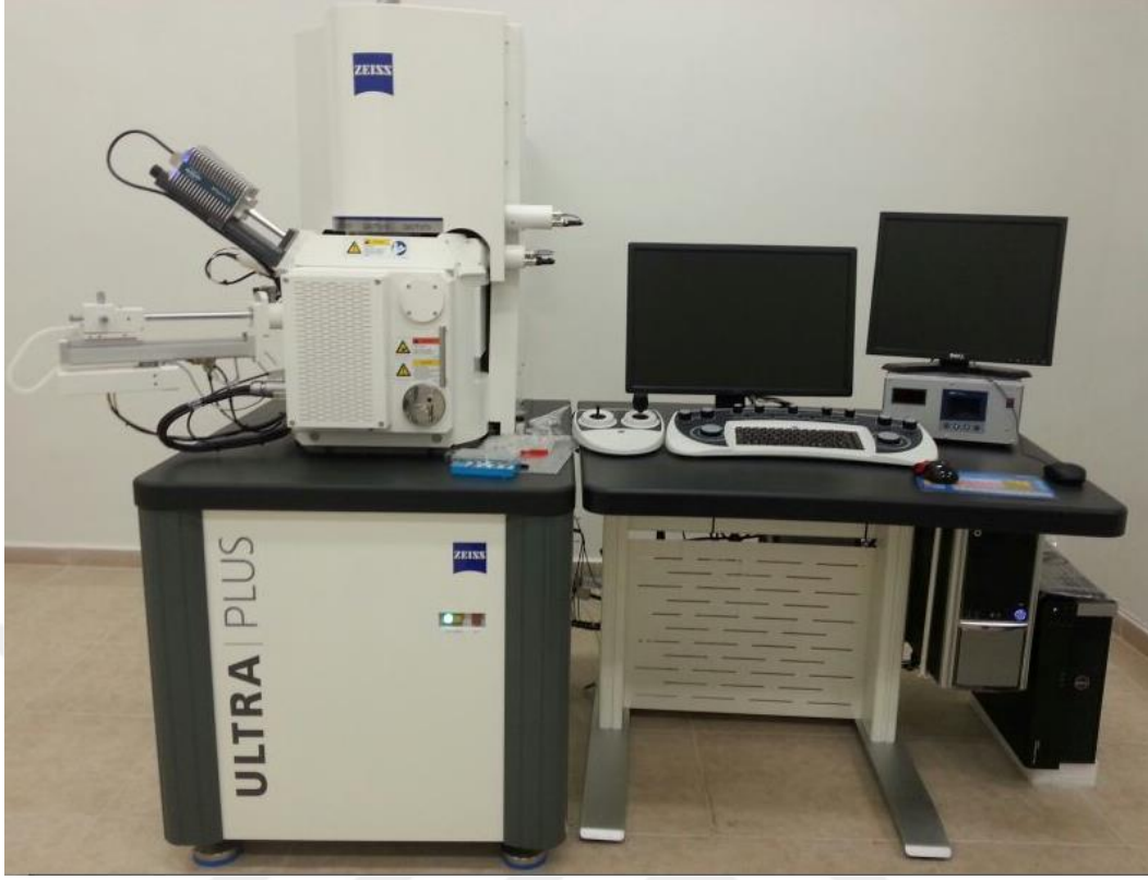
Şekil 5.7. Carl Zeiss Ultra Plus Gemini taramalı elektron mikroskobu [36].
