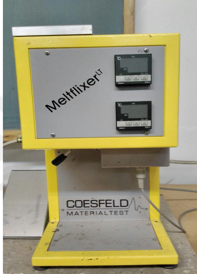
Şekil 5.11. Meltfixer LT marka erime akış indeksi ölçüm cihazı.
