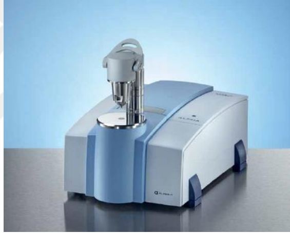
Şekil 5.6. Bruker-Alpha FTIR spektroskopisi [35].
