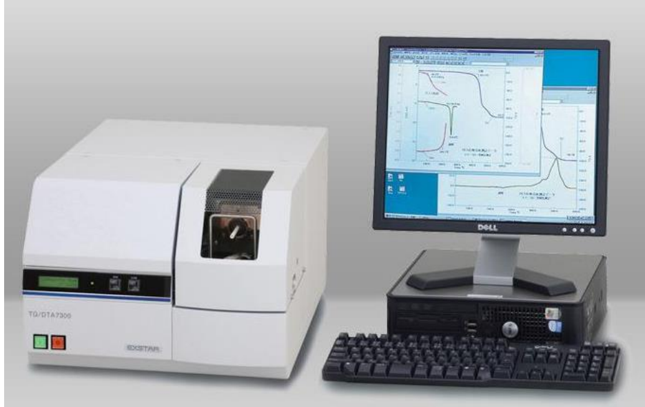
Şekil 5.10. Hitachi STA 7300 marka termogravimetrik analiz cihazı [37].
