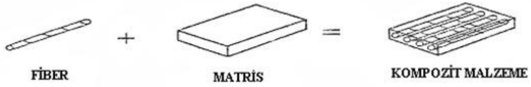
Şekil 4.1 Kompozit malzemenin yapısal birleşiminin bir temsili.
