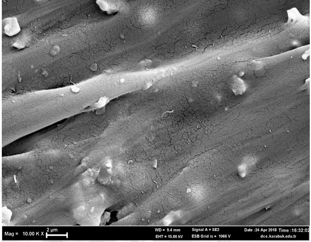
Şekil 6.18. TPU/TAS-Diatomit kompozitinin kırılma yüzeyi görüntüsü.
