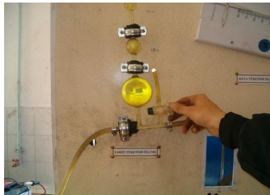
Şekil 6.6 Yakıt tüketimi ölçüm düzeneği.
