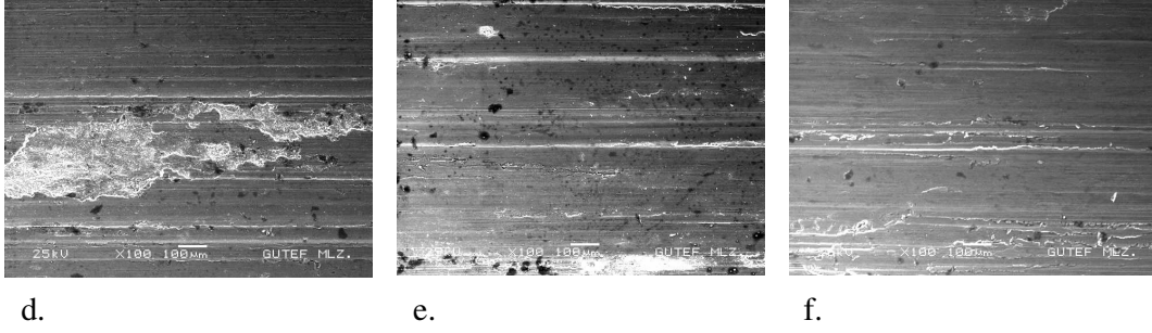
Şekil 7.14 AA 6063 alaşımlı 140 °C’de 2 saat yaşlandırılmış numunelerinin a. 10N yük altında, b. 20 N yük altında, c. 30N yük altında sürtünme katsayısı grafiği ve 140 °C’de 2 saat yaşlandırılmış numunelerinin d. 10 N yük altında, e. 20 N yük altında, f. 30 N yük altında SEM görüntüleri.
