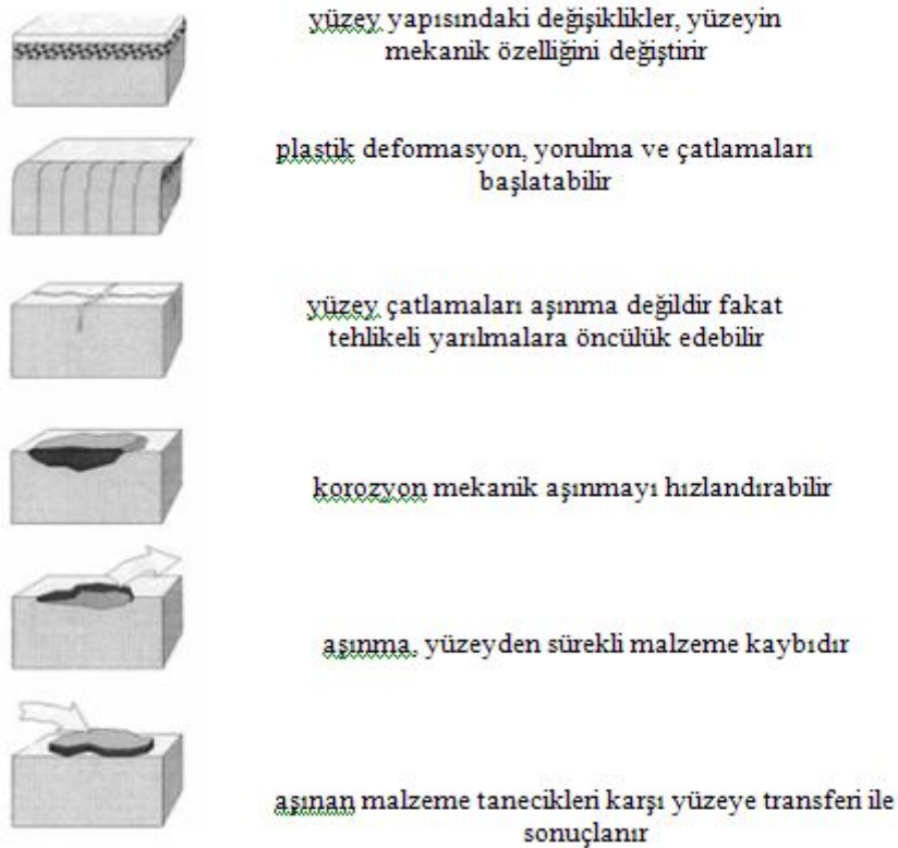
Şekil 4.5 Yüzey aşınma ve bozulmalarının sınıflandırılması (Handbook, 1992).
