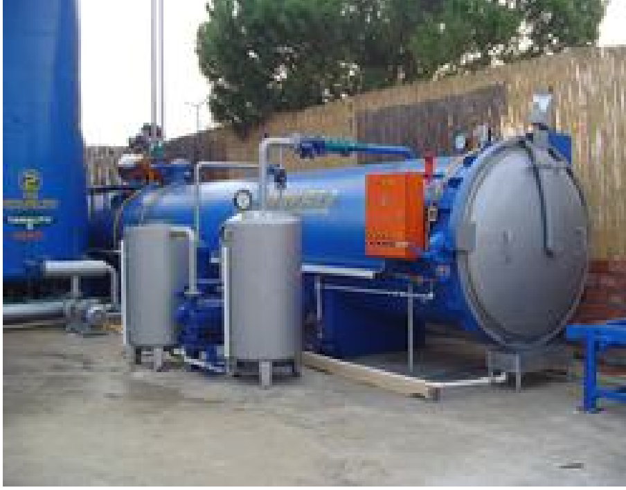
Şekil 3.8 Basınç metoduyla çalışan gelişmiş bir emprenye düzeneği.
