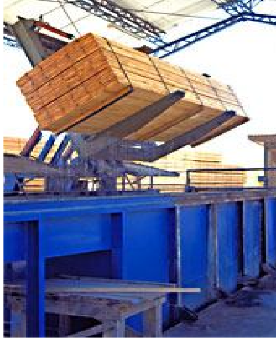
Şekil 3.7 Uzun süreli batırma yönteminde ağaçların kazana yerleştirilmesi.
