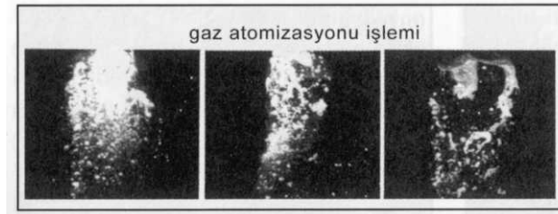
Şekil 2.13. Paslanmaz çeliğin gaz atomizasyonu sırasında meydana gelen türbülans (Fotoğraf: T.Hoffman ve J. Bolsatad).
