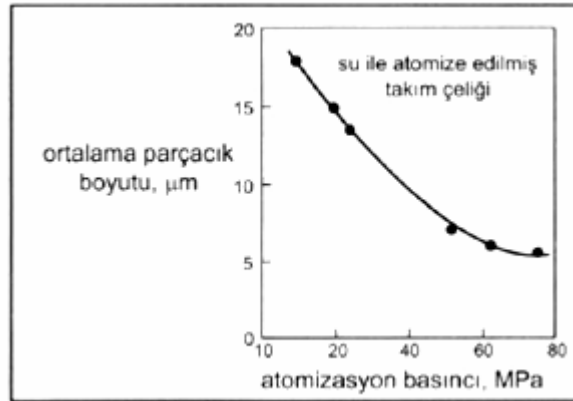
Şekil 2.28. Su ile atomize edilmiş takım çeliği tozlarının ortalama boyutunun basınca göre değişimi. (Weimer, 1997)
