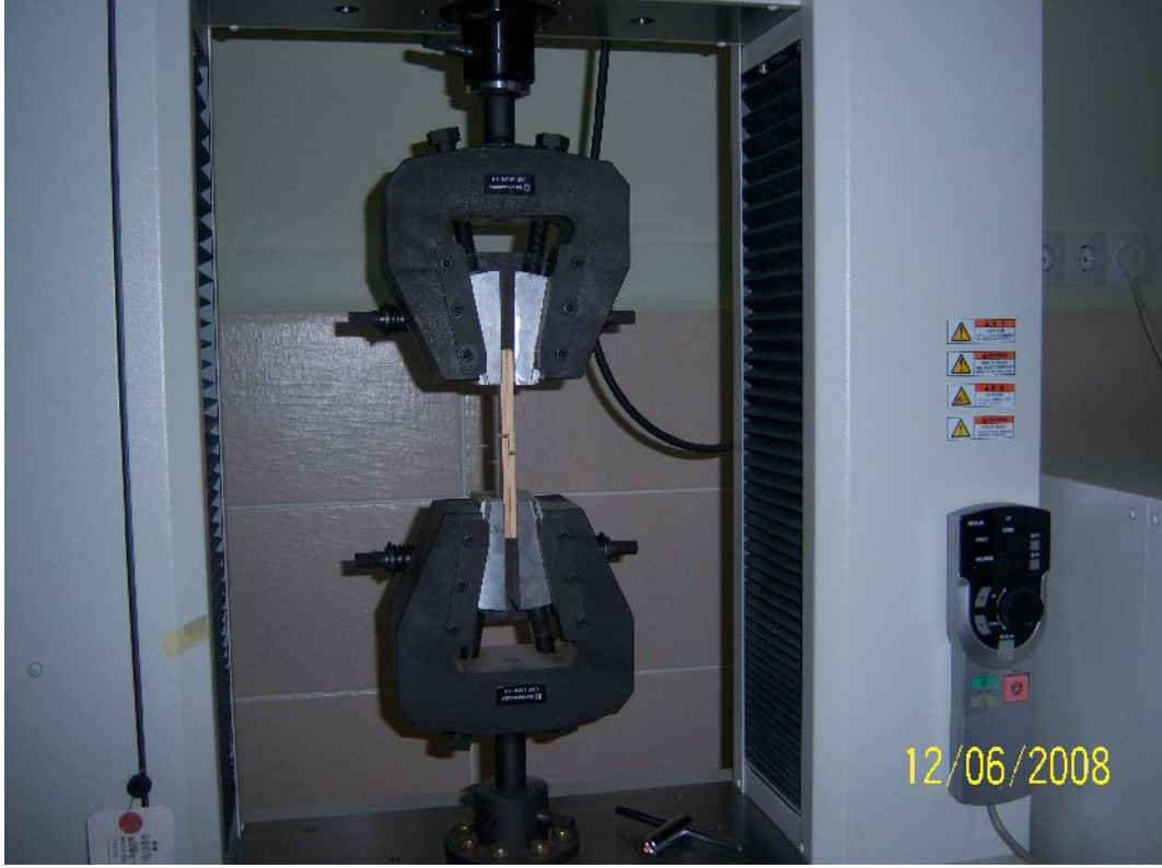
Şekil 3.2. Üniversal test cihazında yapışma direnci deneyi
