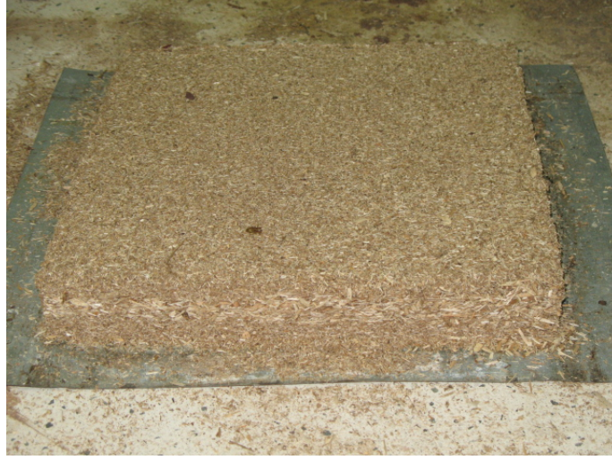
Şekil 2.1. Soğuk preste işlemi yapılmış yonga levha taslağı
