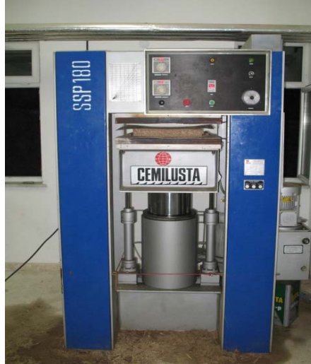
Şekil 2.2. Yonga levha taslağının hidrolik sıcak preste preslenme aşaması
