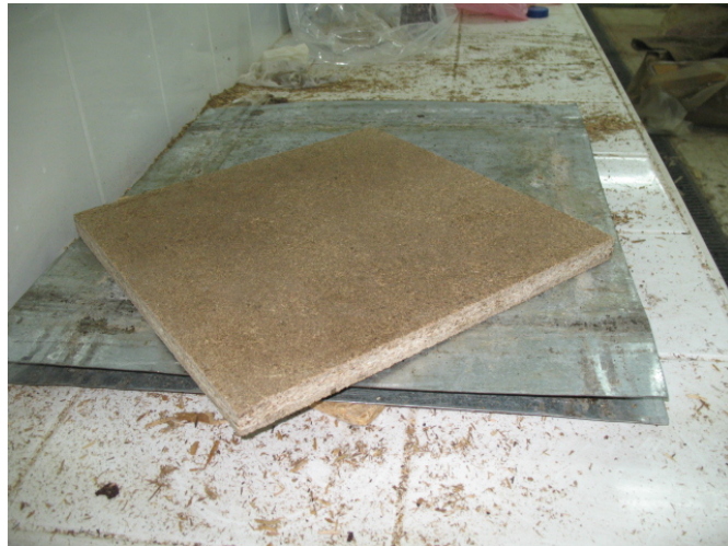
Şekil 2.4. Kenarları alınmış yonga levha
