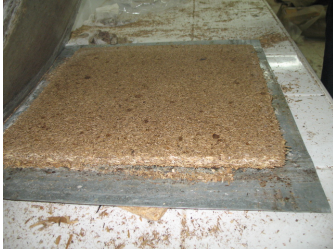
Şekil 2.3. Sıcak pres uygulanmış yonga levha taslağı
