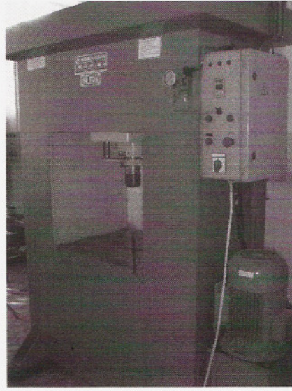
Şekil 5.2 Al-SiC p toz karışımının basıldığı pres.
